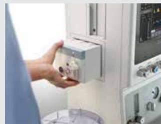
Con un módulo de CO<sub>2</sub> de ranura simple mejorado o con la capacidad del agente anestésico de ranura doble, los módulos multigas tipo Plug-and-Play brindan un análisis exhaustivo de respiración a respiración de FIO<sub>2</sub>, EtO<sub>2</sub>, CO<sub>2</sub>, N<sub>2</sub>O y permiten la autodetección de BIS y de cinco agentes anestésicos.
